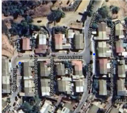
Imagen N°11: Muestra sobre ortofoto la ubicación de los 2 PRs GPS medidos en calle Lenox y Darwin los PRs se simbolizan con puntos en color azul.
