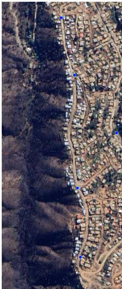
Imagen N°8 Muestra en puntos de color azul los 5 PRs medidos para apoyar el levantamiento topográfico del sector incendiado en Vista Las Palmas el verano de 2023
